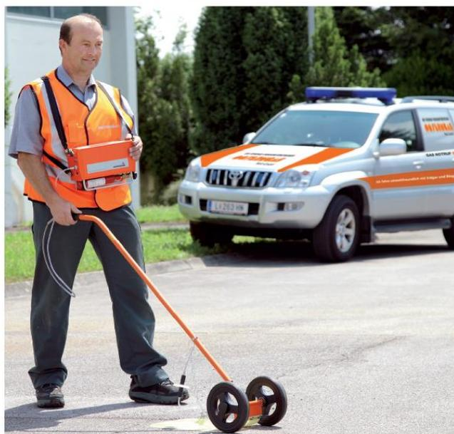
Im Zuge der routinemäßigen Wartung des Erdgasleitungsnetzes wird die Trasse mit dem Gasspürgerät abgegangen und dabei auf volle Funktionstüchtigkeit geprüft.
